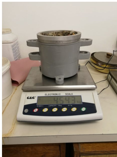
Slika 17. Vaganje kalupa sa uzorkom
