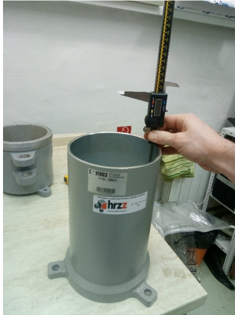
Slika 12. Određivanje visine cilindra iznad kalupa
