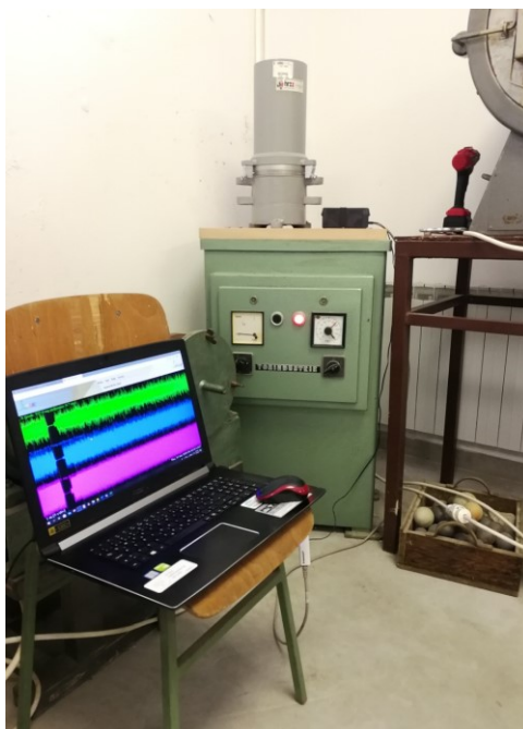
Slika 9. Utvrđivanje frekvencije titranja vibro ploče
