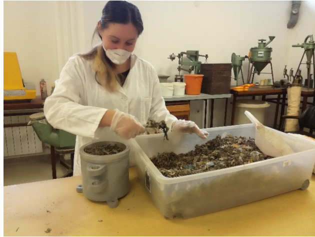
Slika 16. Punjenje kalupa uzorkom
