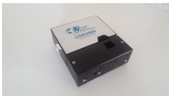
Slika 15 Spektrofotometar Ocean Optics.
