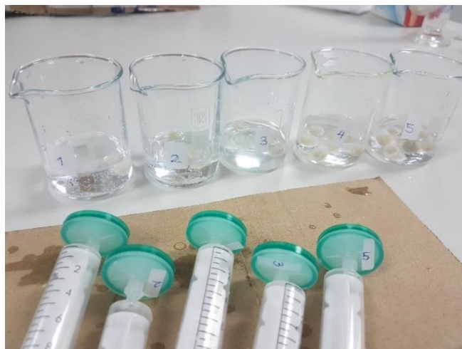
Slika 14 Adsorpcija na okruglim filcanim uzorcima vune u otopini imidakloprida
