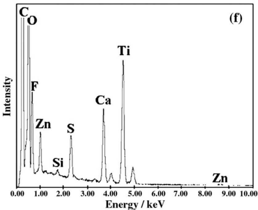
Slika 30. Rezultati EDX koji odgovaraju (c), (Zn, Ca, S i C dolaze iz NR podloge, F dolazi iz reakcijske otopine, a Si dolazi iz sloja  $\text{SiO}_2$ ) [13]
