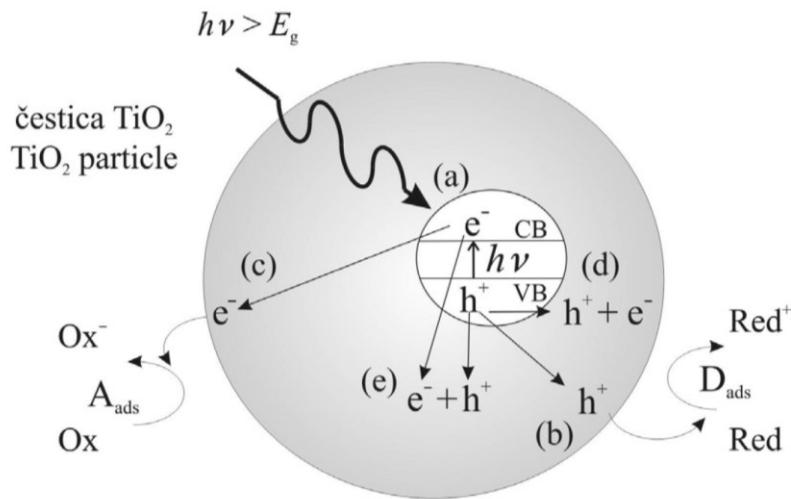
Slika 4. Glavni procesi u čestici poluvodiča  $\text{TiO}_2$ : (a) nastajanje para elektron-šupljina, (b) oksidacija adsorbirane molekule  $D$ , (c) redukcija adsorbirane molekule  $A$ , (d) rekombinacija na površini čestice, (e) rekombinacija u unutrašnjosti čestice [6]
