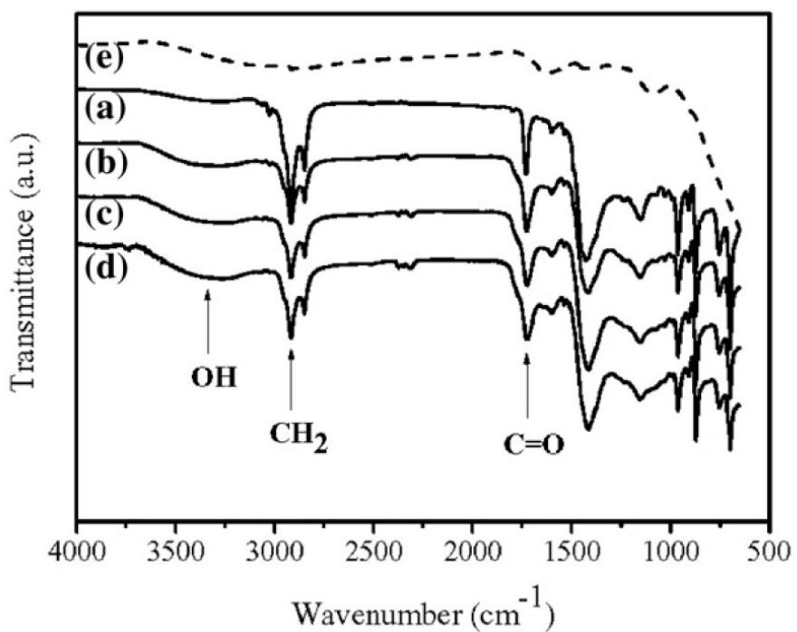
Slika 24. ATR-FT-IR spektri površina prirodne gume: (a), netretirani NR; (b), NR tretiran UV/ozonom 20 min, (c), 40 min, (d), 60 min, (e) predstavlja spektar NR
