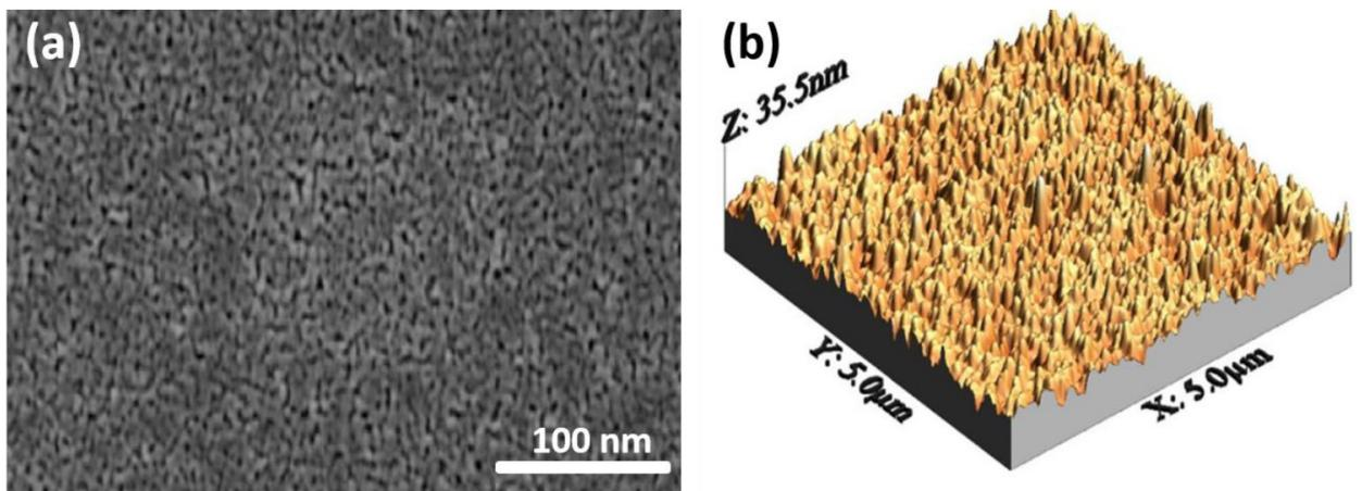
Slika 19. (a) SEM slika TiO<sub>2</sub> tankog filma sintetiziranog premazom i (b) AFM slika (topografski prikaz) TiO<sub>2</sub> tankog filma [12]
