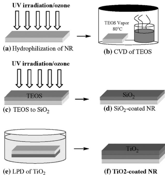
Slika 22. Shematski prikaz pripreme slojeva SiO<sub>2</sub> i TiO<sub>2</sub> na podlozi od prirodne gume [13]
