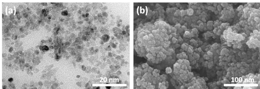
Slika 15. a) TEM prikaz TiO<sub>2</sub> nanočestica b) SEM prikaz TiO<sub>2</sub> nanočestica [12]
