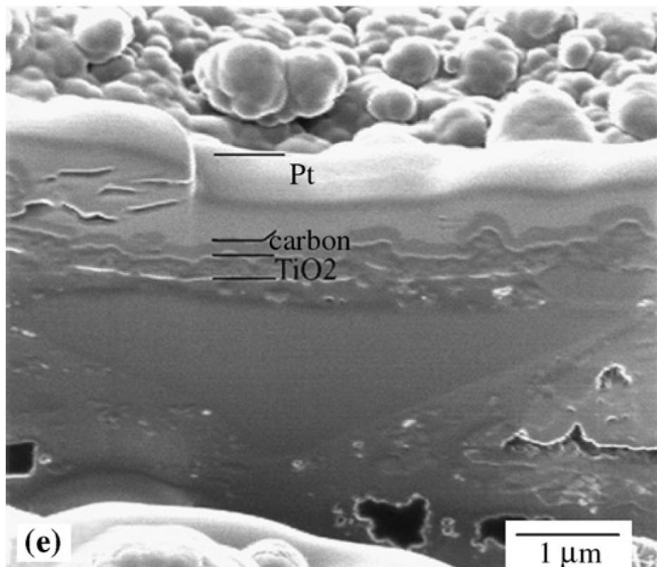
Slika 29. Presjek uzorka prirodne gume presvučene  $\text{TiO}_2$  [13]
