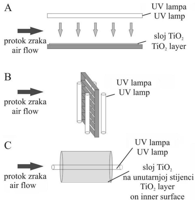
Slika 5. Shematski prikaz raspodjela fotokatalitičkih reaktora s obzirom na smjer reakcije, položaj UV-lampe i smještaj katalizatora: (a) tip reaktora s ravnom pločom, (b) saćasti monolitni tip reaktora i (c) cijevni (anularni) reaktor [4]
