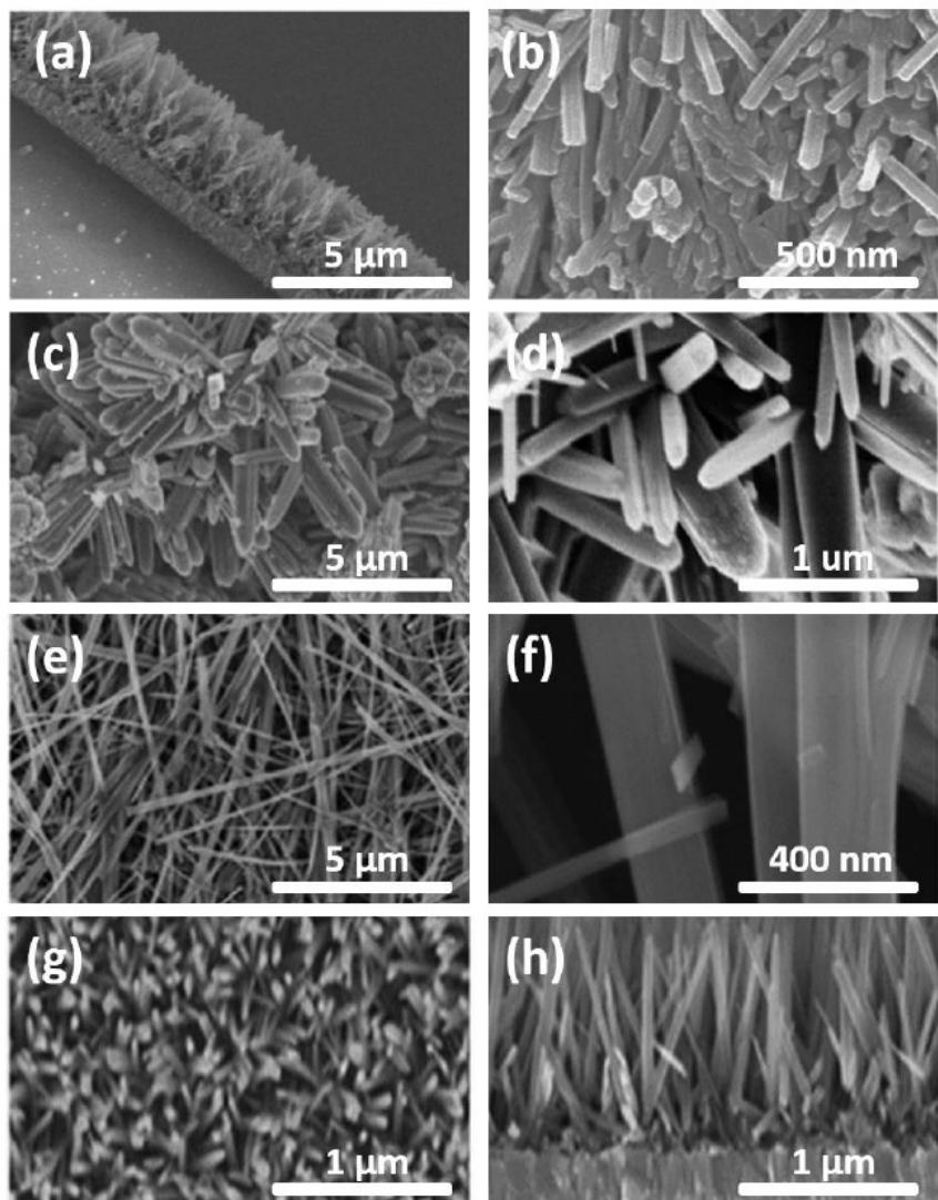
Slika 17. Različite vrste morfologije 1D  $\text{TiO}_2$  nanostruktura sintetiziranih hidrotermalnim metodama: (a, b)  $\text{TiO}_2$  nanocijevi, (c, d)  $\text{TiO}_2$  nanočepići, (e, f)  $\text{TiO}_2$  nano trake, (g, h)  $\text{TiO}_2$  nanožice [12]
