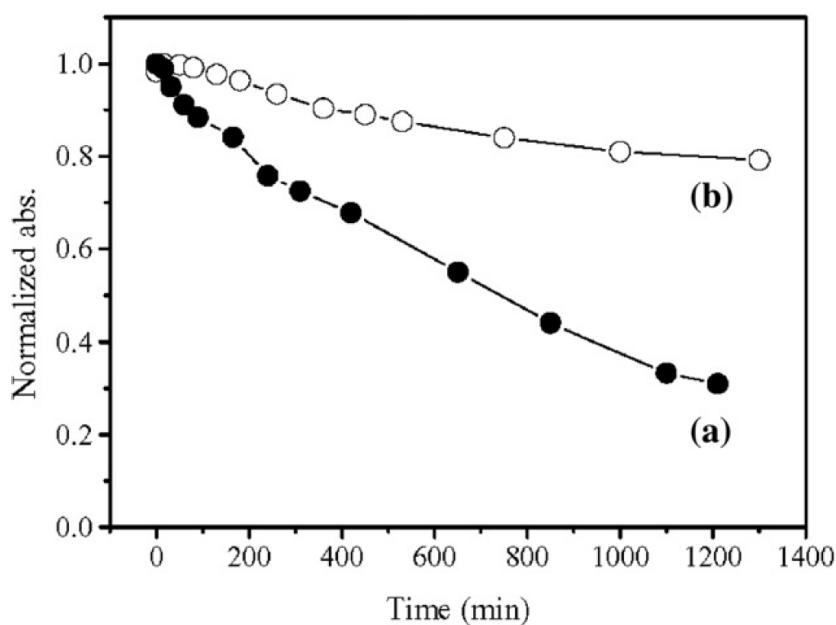
Slika 32. Fotokatalitička razgradnja metilen plavog pomoću uzorka NR presvučenog TiO<sub>2</sub>: (a), u ovisnosti o vremenu osvjetljenja žarulje svjetlosti jačine  $1 \text{ mW cm}^{-2}$ ; (b) predstavlja apsorpciju uzorka u mraku [13]
