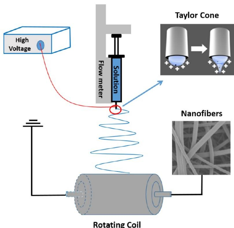
Slika 16. Shematski prikaz metode elektrospinninga [12]
