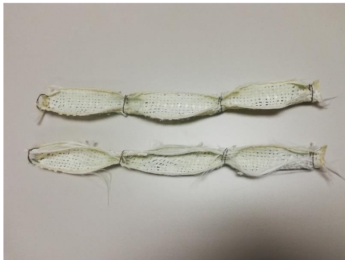
Slika 23 Izrezani fotokatalizator korišten u CPC reaktoru
