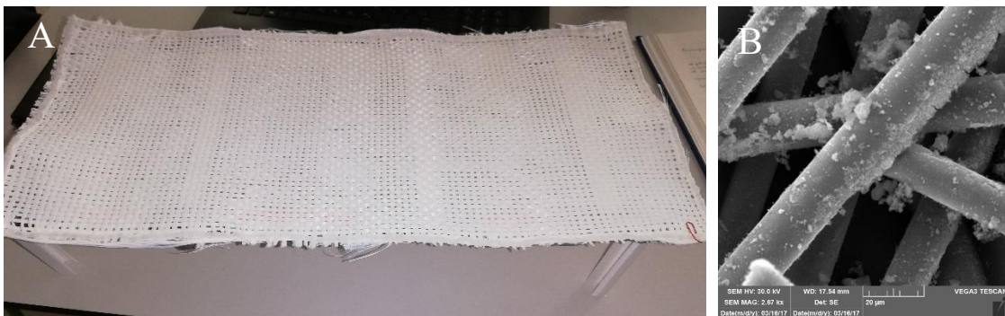
Slika 22 (A) Originalna mreža s nanesenim TiO 2 ; (B) SEM slika mreže s nanesenim TiO 2
