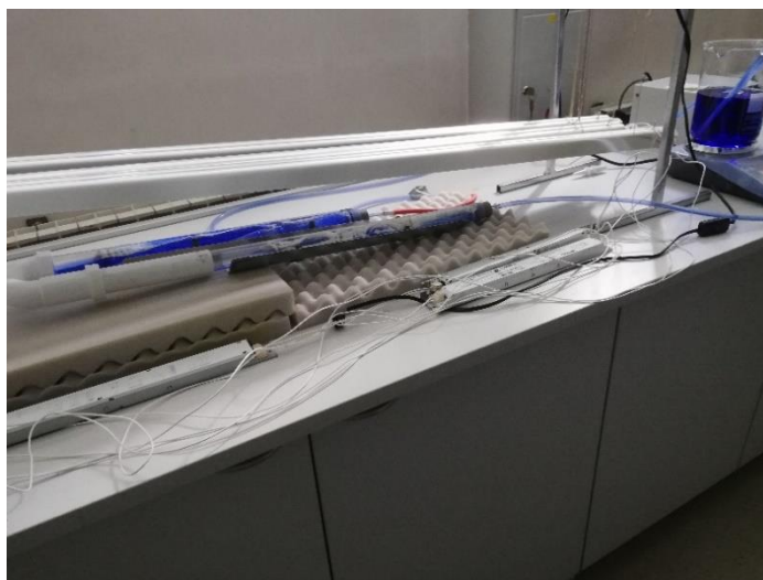
Slika 27 Eksperimentalni postav pročišćavanja vodene otopine metilenskog modrila fotokatalizom
