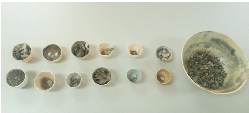
Slika 7: Komponente reprezentativnog uzorka prije i poslije žarenja
