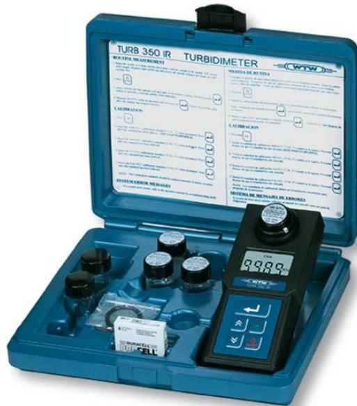
**Slika 1.** Prijenosni turbidimetar [8]
