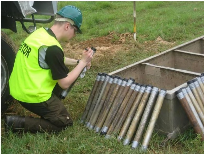
Slika 16 - Označavanje neporemećenih uzoraka tla na terenu [10]
