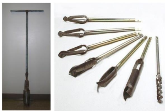
Slika 15. Cjevaste i žljebaste sonde za uzorkovanje tla [34]
