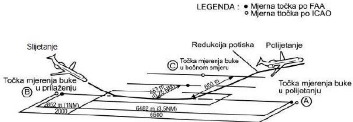
Slika 2: Referentne točke mjerjenja razine buke zrakoplova pri slijetanju i polijetanju
