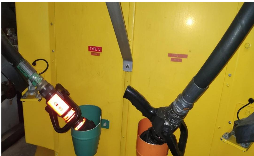
Slika 7: : Mlaznice za raspršivanje sredstva za odleđivanje
