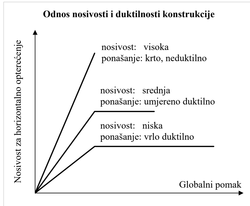
Slika 19. Odnos između duktilnosti i nosivosti građevine (Grandić, 2015.)
