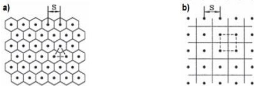
Slika 9. Raspored šljunčanih pilota: a) trokutasti b) pravokutni (prema Wang, 2009.).
