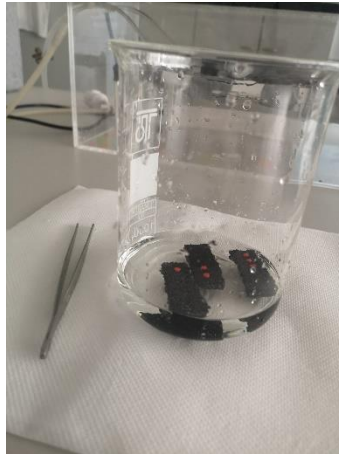
Slika 4. Prikaz umakanja gumenih podloga u otopinu NaOH
