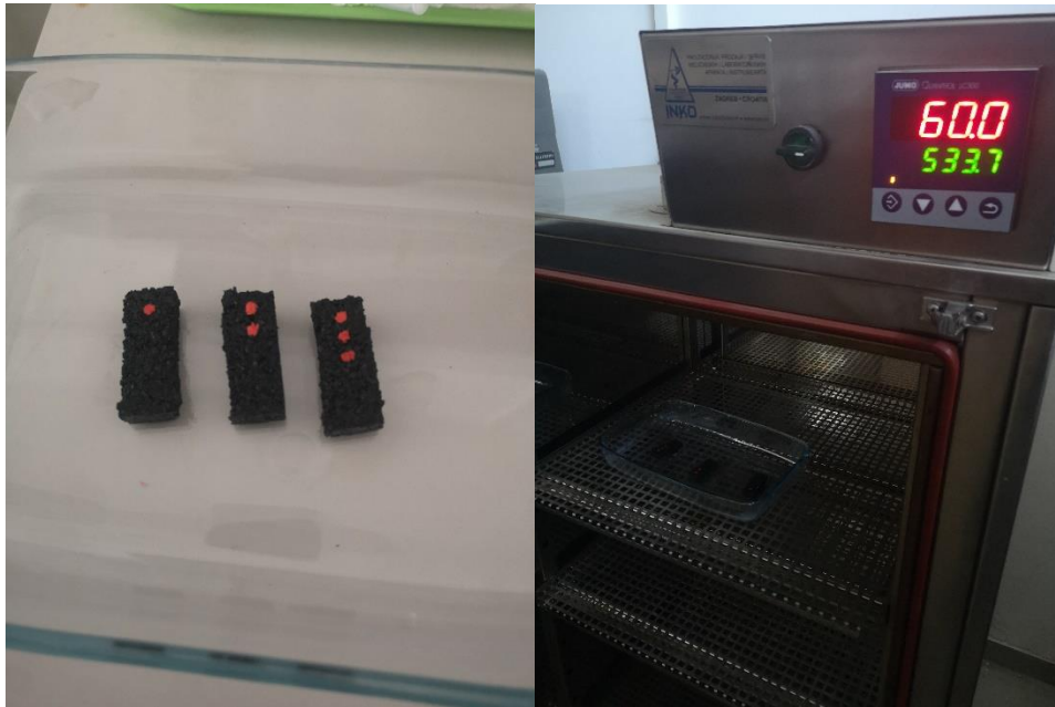
Slika 5. Gumene podloge u staklenoj lađici (lijevo) i gumene podloge u sušioniku (desno)
