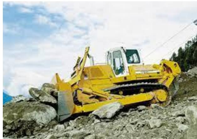
Slika 4.3. Dozer s rijačem (Preuzeto sa [www.grad.unizg.hr](http://www.grad.unizg.hr))
