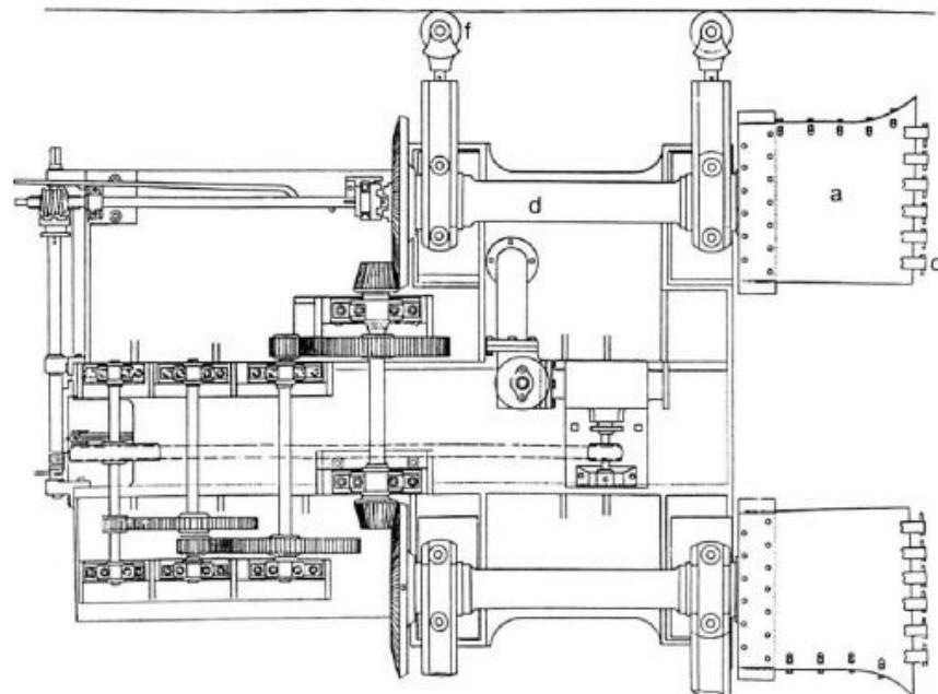
Slika 4.6. Stroj s dvije rotirajuće rezne glave [14]
