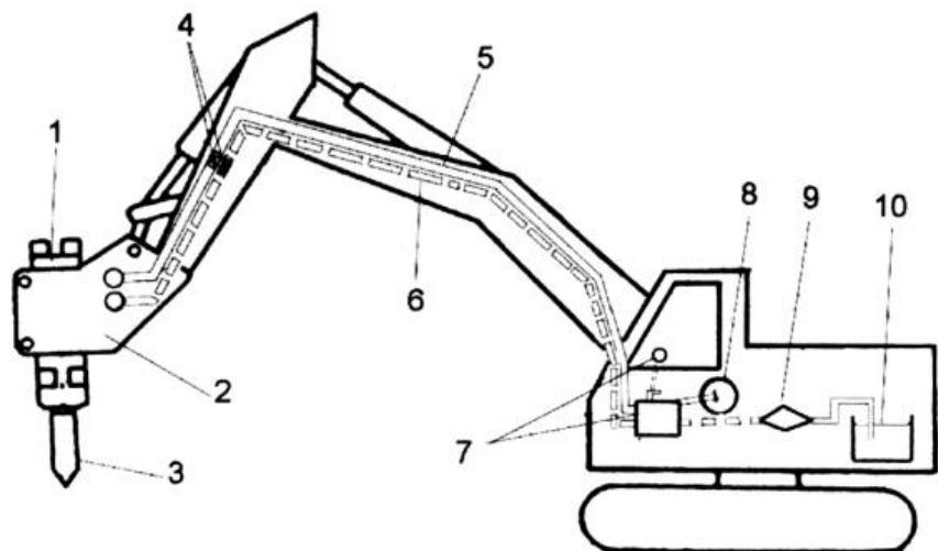
Slika 4.5. Povezivanje čekića na hidraulični sustav bagera [14]
