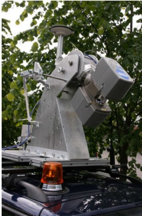
Slika 12. Instrument Roamer sa skenerom nagnutim u smjeru unatrag [16]
