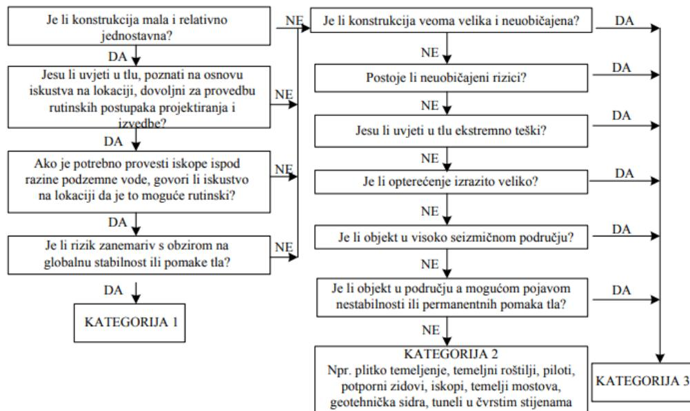
Slika 4 - Prikaz dijagrama toka za određivanje geotehničke kategorije
