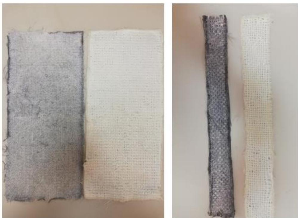
Slika 11 Korišteni TiO<sub>2</sub> (bijela mreža) i TiO<sub>2</sub>/CNT (crna mreža) fotokatalizatori za FPCR reaktor (lijeva slika) i CPC reaktor (desna slika)
