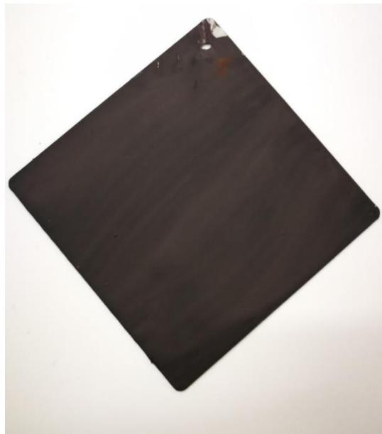
Slika 29. Pločica premazana destilacijskim muljem FP3 -210202-2 bez nadorade
