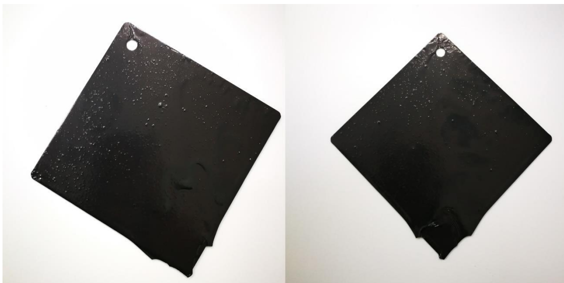
Slika 25. Pločica premazana otpadnim muljem FP1-210210-1 u koji je dodano 10% originalnog otapala
