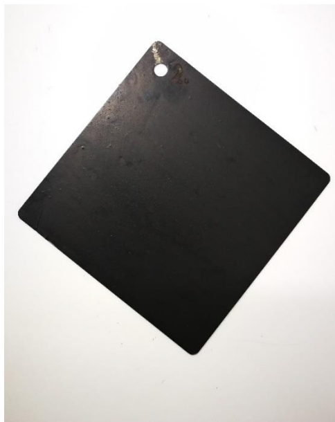
Slika 36. Pločica premazana destilacijskim muljem FP1-210205-1 bez prethodne nadorade dodatkom bitumena
