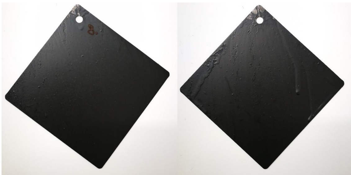
Slika 22. Metalna pločica sa premazom od mješavine najperspektivnijih uzoraka
