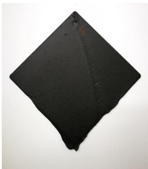
Slika 26. Pločica premazana destilacijskim muljem FP3 -210202-1 bez nadorade
