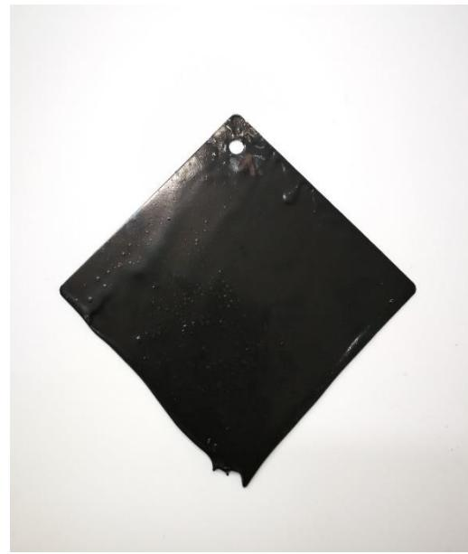
Slika 23. Pločica premazana destilacijskim muljem FP1-210210-1 bez nadorade
