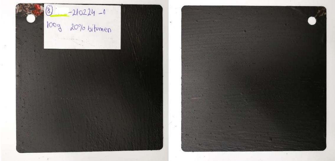
Slika 46. Pločica premazana destilacijskim muljem FP2-210224-1 s dodatkom 20% bitumena
