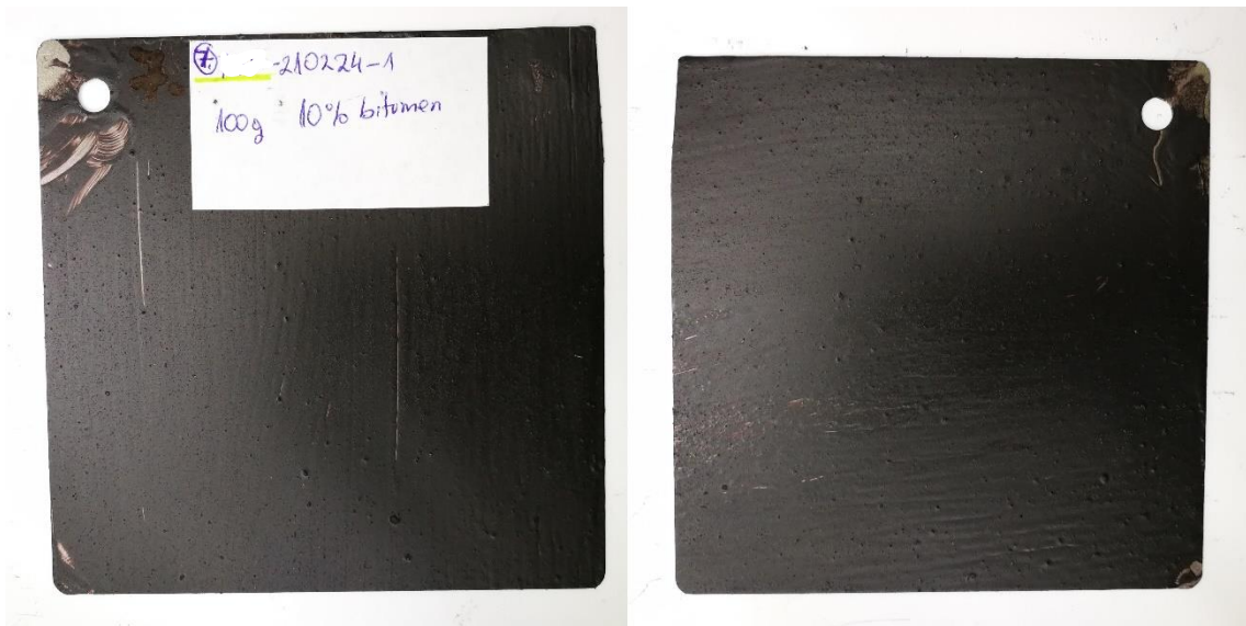
Slika 45. Pločica premazana destilacijskim muljem FP2-210224-1 s dodatkom 10% bitumena
