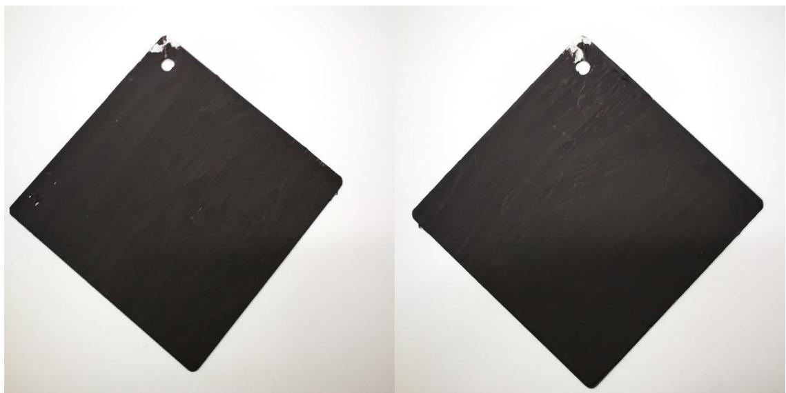
Slika 27. Pločica premazana destilacijskim uljem FP3-210202-1 u koji je dodano 5% regenerata
