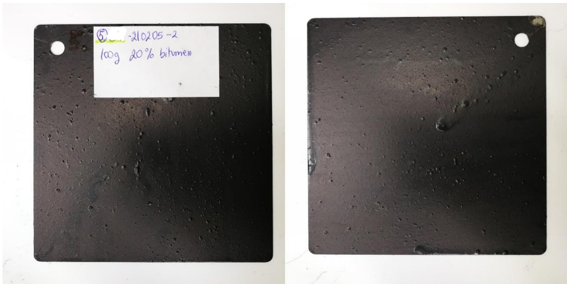
Slika 42. Pločica premazana destilacijskim muljem FP1-210205-2 s dodatkom 20% bitumena
