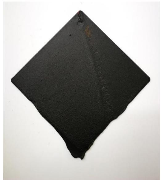
Slika 26. Pločica premazana destilacijskim uljem FP3 -210202-1 bez nadorade
