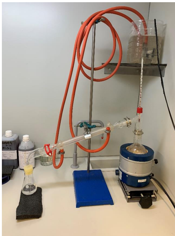
Slika 3. Prikaz postupka probne destilacije u Laboratoriju za organska otapala u tvrtki Premifab d.o.o. – simulacija procesa destilacije te dobivanja postotka iskoristivosti procesa odnosno regenerabilnosti uzorka
