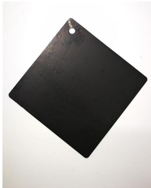
Slika 36. Pločica premazana destilacijskim muljem FP1-210205-1 bez prethodne nadorade dodatkom bitumena
