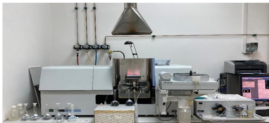
**Slika 15.** Atomski apsorpcijski spektrometar AAnalyst 800
