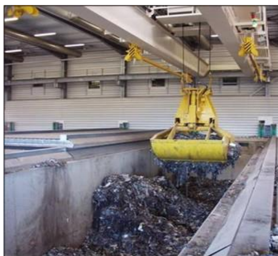
Slika 2. Premještanje biosušenog otpada procesnim kranom iz betonske komore (Preuzeto iz: Hidroplan d.o.o., 2014.)
