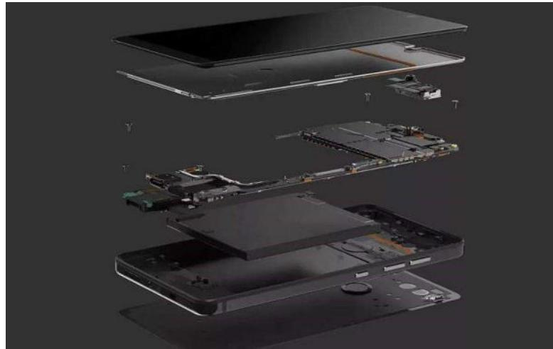
Slika 5: Kućište mobitela [26]
