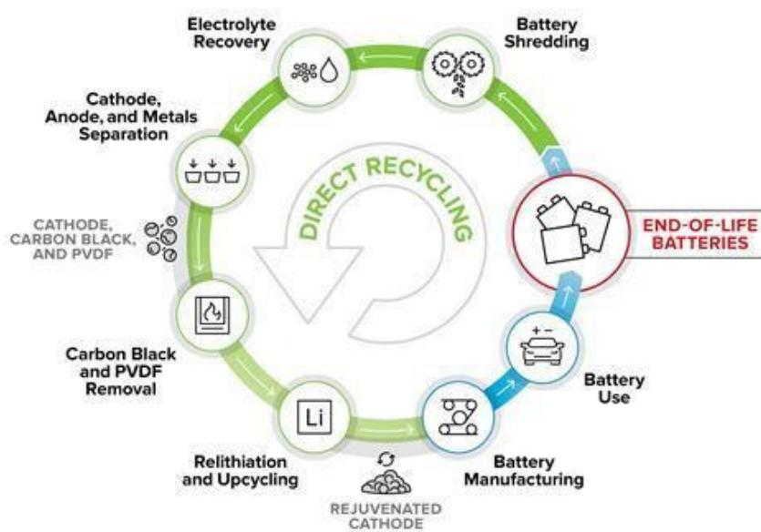
Slika 8: Shematski prikaz recikliranja litijskih baterija [49]
