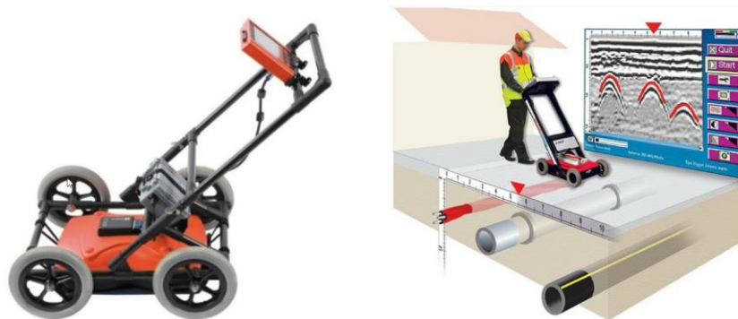
Slika 14. Georadar i princip istraživanja metodom georadara [15]
