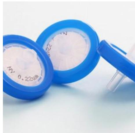
**Slika 17.** Filteri za filtriranje vode kod ionske kromatografije [68]
