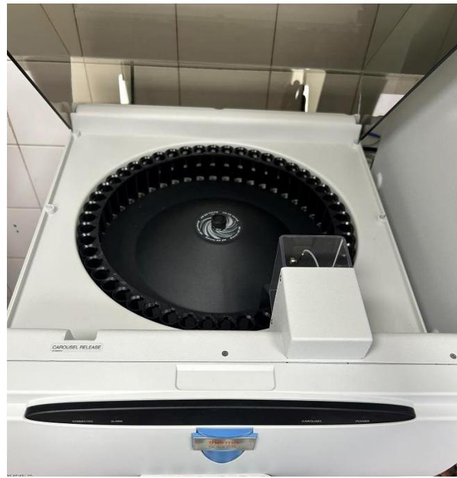
**Slika 19.** Autosampler (dio ionskog kromatografa)
