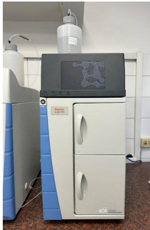
**Slika 16.** Ionski kromatograf Dionex Integron HPIC
