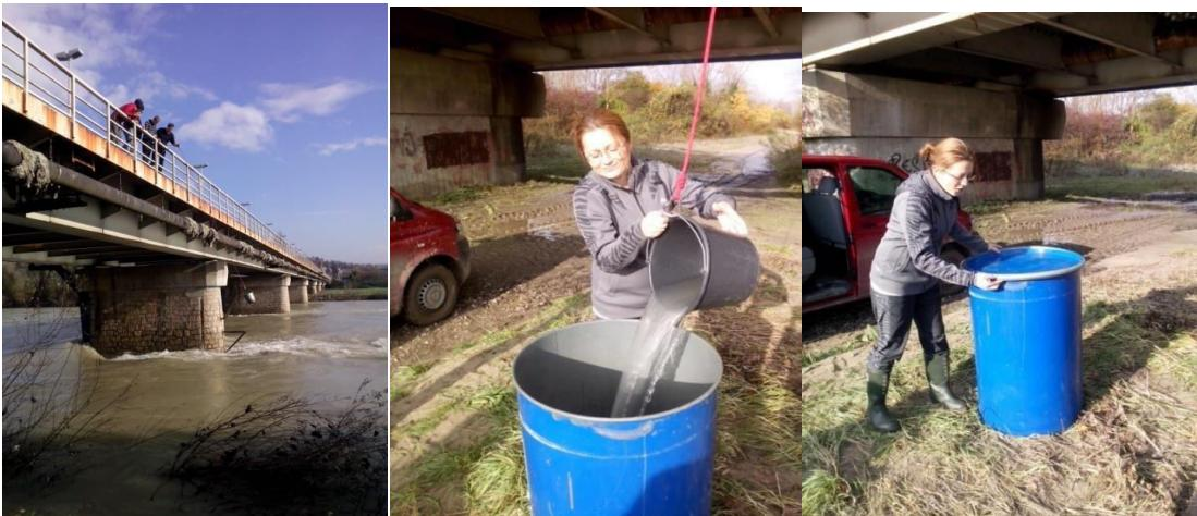
**Slika 30.** Uzrokovanje za granulometrijsku analizu suspendiranog nanosa [34]
