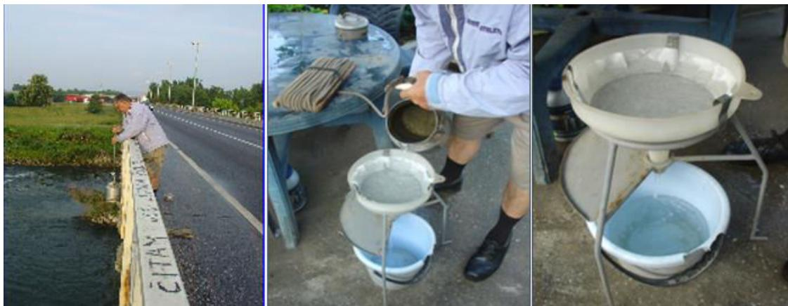
**Slika 19.** Uzorkovanje vode za analizu suspendiranog nanosa [31]
