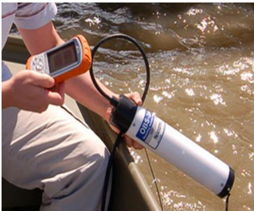
Slika 21. Optički senzor za mjerenje mutnoće
