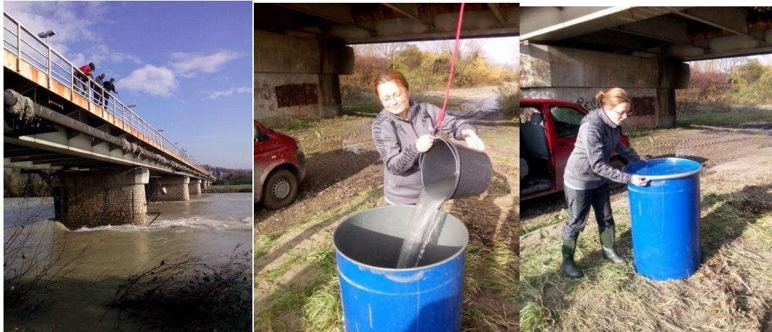
Slika 30. Uzorkovanje za granulometrijsku analizu suspendiranog nanosa [34]
