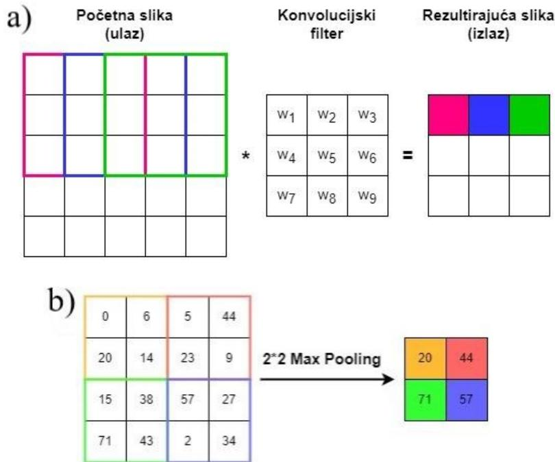
Slika 19. Operacije u slojevima konvolucijske neuronske mreže: a) Konvolucijski sloj, b) Pooling sloj
