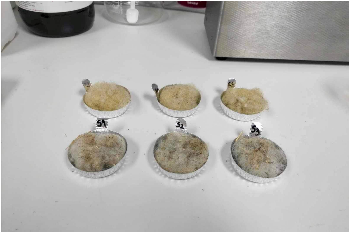
Slika 13 Uzorci neobrađene sirove vune nakon adsorpcije
