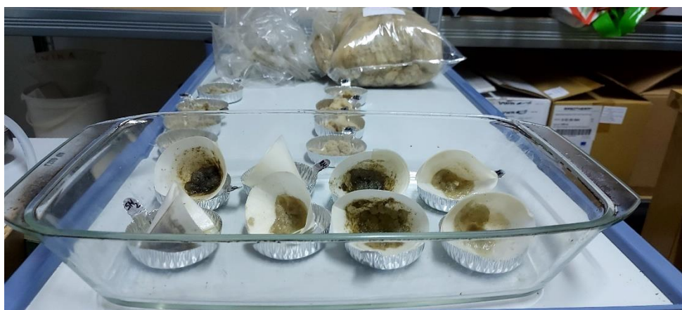
Slika 15 Uzorci obrađe ( mljevene ) sirove vune nakon adsorpcije
