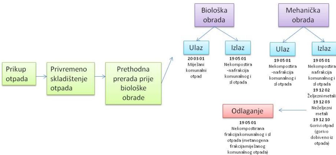
Slika 6 Shematski prikaz tehnoloških procesa i ključnih brojeva [28]
