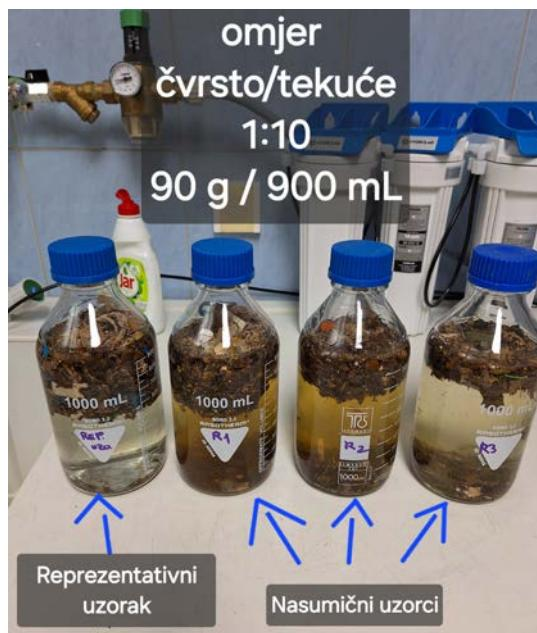
Slika 13 Priprema uzoraka za test izluživanja
