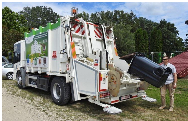
Slika 13 - posebna autosmećarka za sakupljanje biootpada
