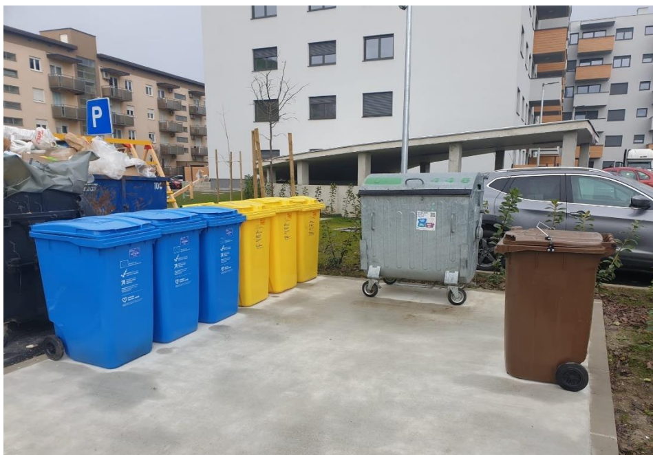
Slika 10 - Kombinacija spremnika od 240L (biootpad), 360L (papir i plastika) i 1100L (MKO)
