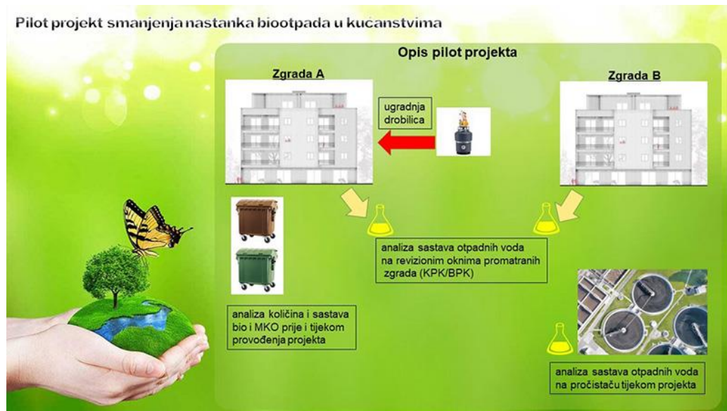
Slika 19 - Pilot projekt ugradnje drobilica u Virovitici – hodogram [31]
