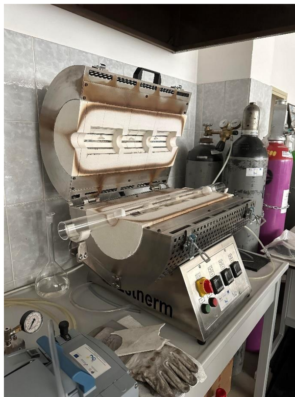
Slika 11: Peć za provedbu vakuumske pirolize
