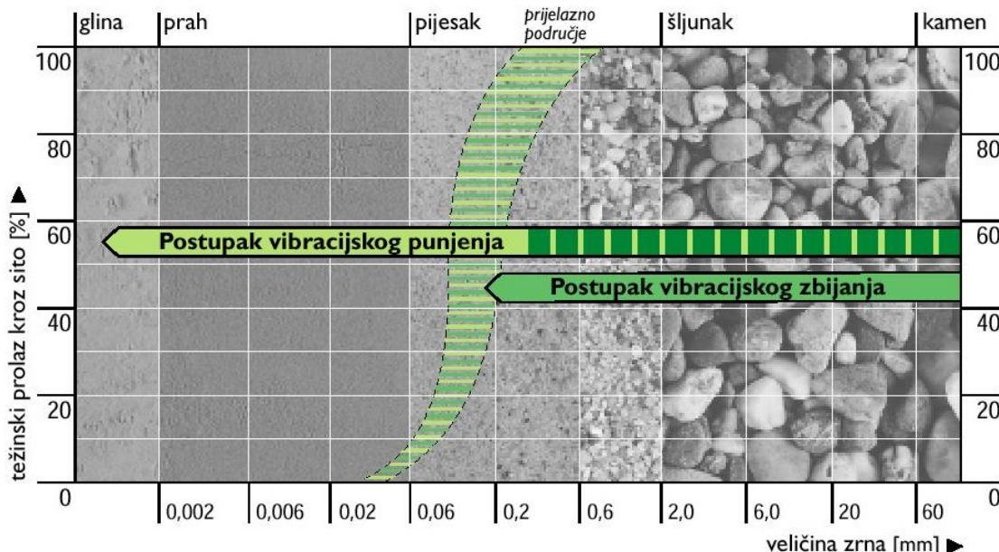
Slika 11. Granice primjene postupka dubinskog vibracijskog zbijanja
