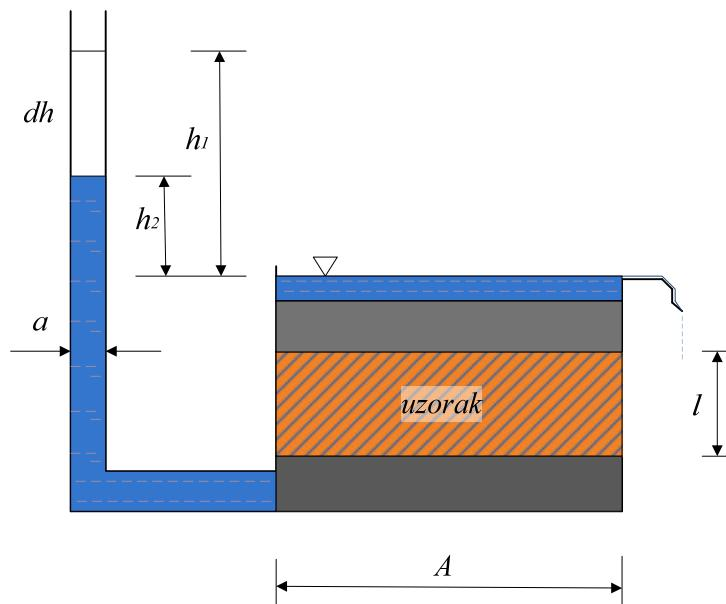
Slika 8. Shema mjerjenja koeficijenta propusnosti s promjenjivim padom potencijala (Kvasnička; Domitrović, 2007).
