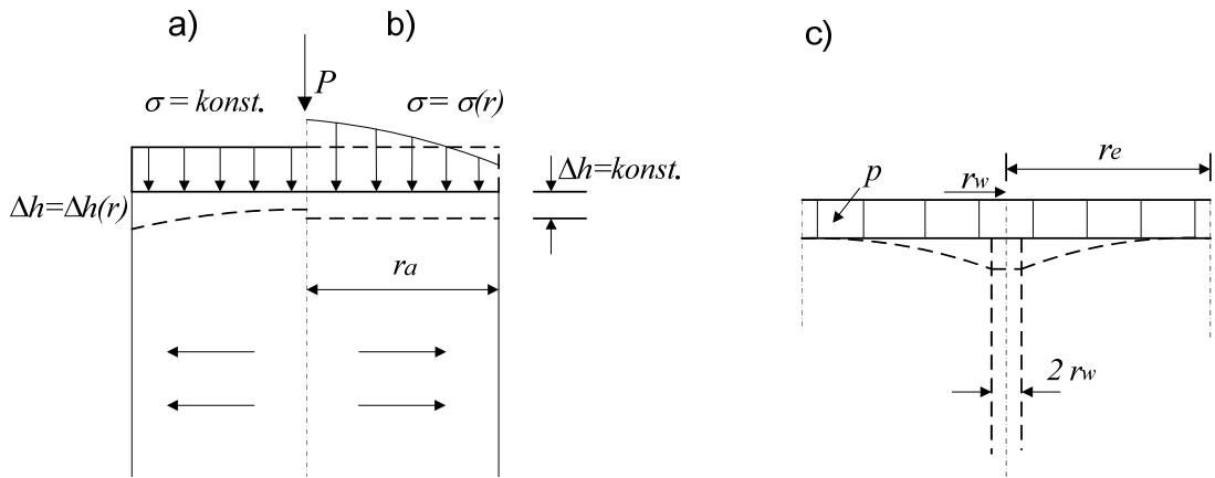
Slika 6. Ovisnost radijalne konsolidacije oko drena za različite načine opterećivanja površine: a) kontinuirano opterećenje, b) fleksibilno opterećenje, c) opterećenje preko krute plohe (iz Nonveiller, 1979).
