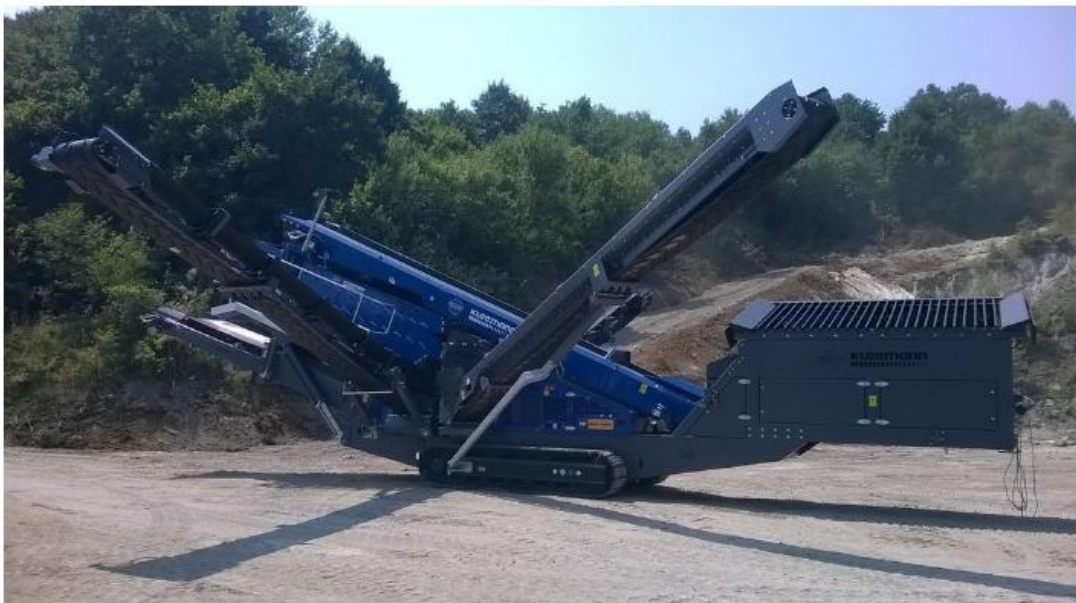
Slika 13. Postrojenje za sisanje s troetažnim sitom
