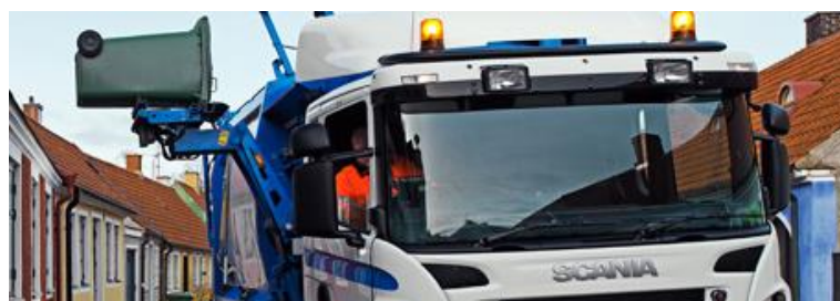
Slika 9. Kamion s bočnim načinom sakupljanja otpada [12]
