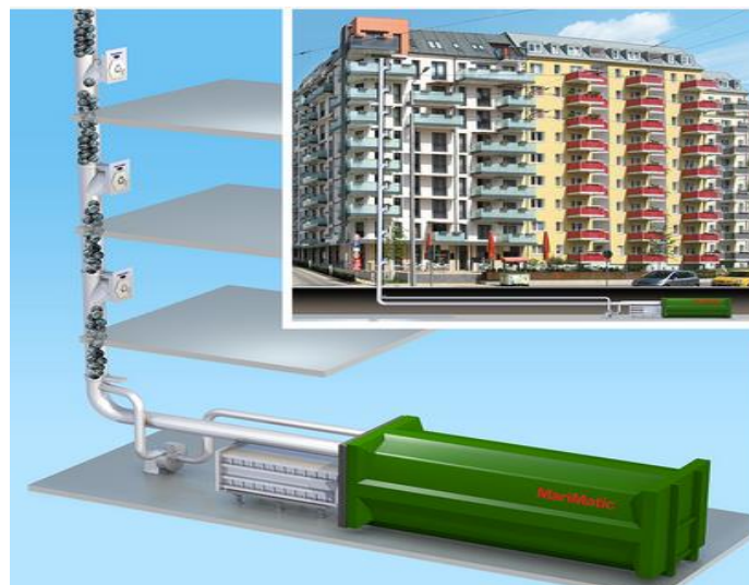
Slika 7. Postrojenje za pneumatski transport otpada [11]
