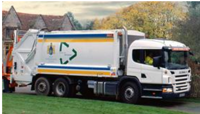
Slika 8. Kamion sa stražnjim načinom sakupljanja otpada [12]
