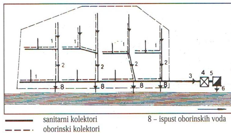
Slika 4. Prikaz razdjelnog tipa kanalizacijskog sustava [2]
