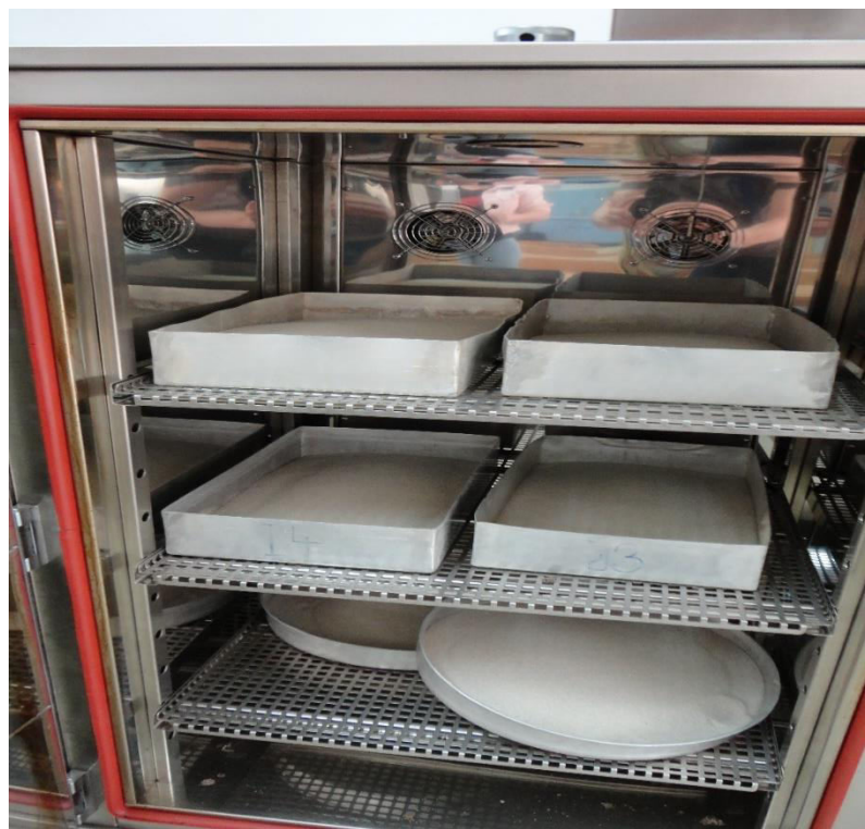
Slika 8. Sušenje pijeska u sušioniku
