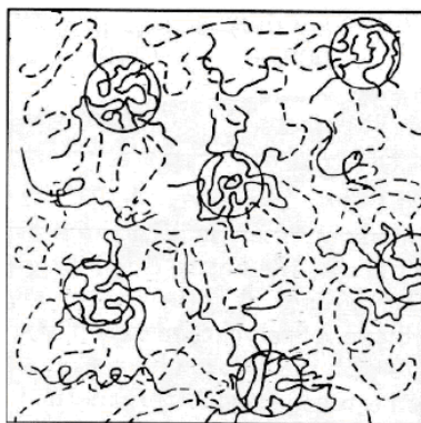
Slika 13. Djelomično mješljiva mješavina polimera A ( puna linija ) i B ( iscrtkana linija )
