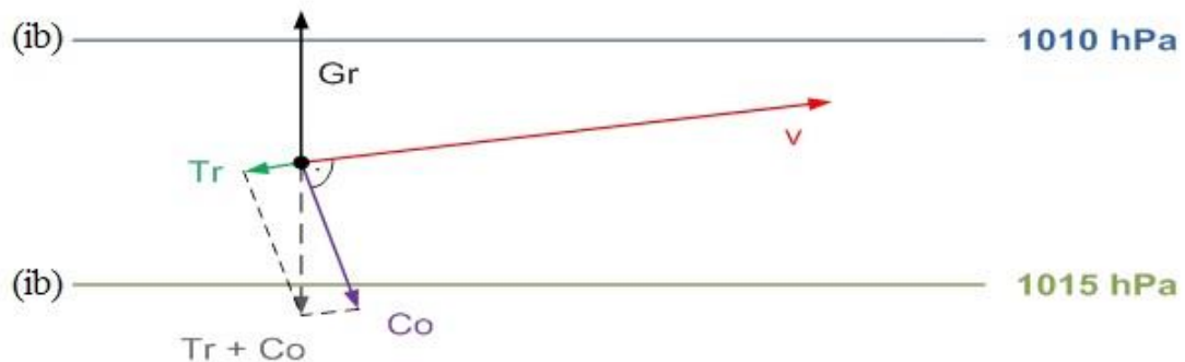
Slika 10. Smjer prizemnog vjetra na sjevernoj polutci pri pravocrtnim izobarama nakon uspostave ravnoteže među silama Gr , Co i Tr [11].
