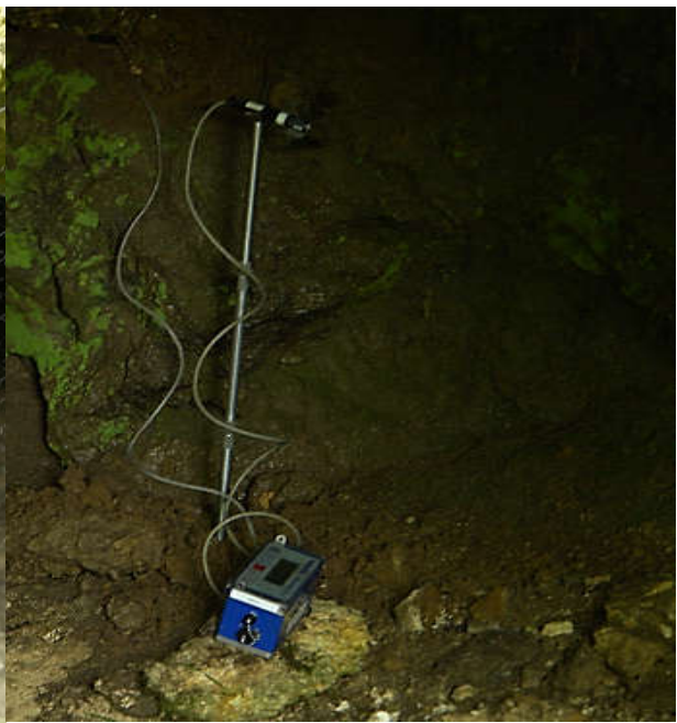
Slika 6.6 Uređaj za mjerenje vibracija i buke u ulaznom djelu špilje
