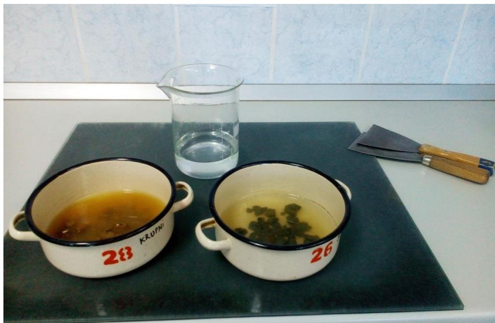
Slika 23.Priprema uzorka za areometriranje
