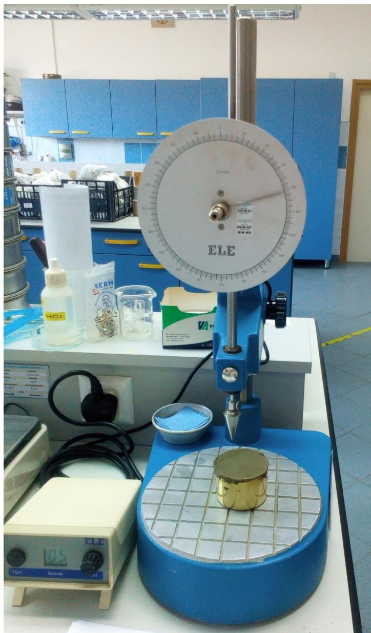
Slika 19.Određivanje granice tečenja pomoću konusnog penetrometra
