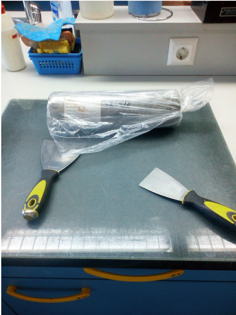
Slika 17. Neporemećeni uzorak tla
