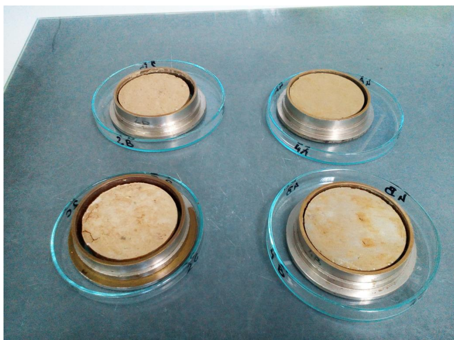
Slika 26. Uzorak nakon pokusa u edometru
