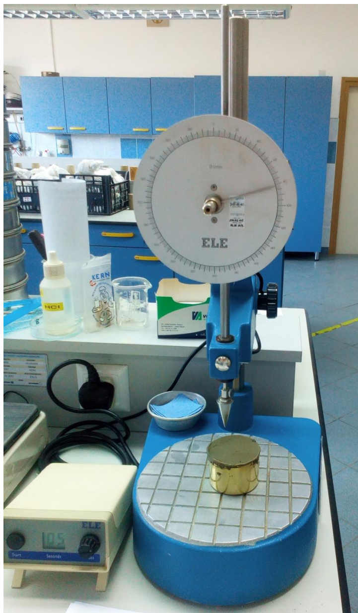
Slika 19. Određivanje granice tečenja pomoću konusnog penetrometra
