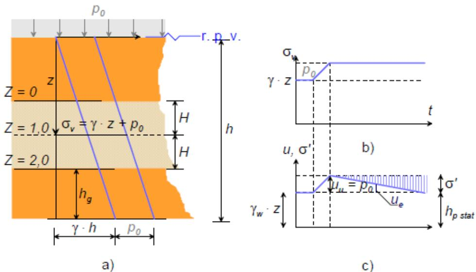
Slika 9. a) Skica početnih i dodatnih naprezanja za rješavanje jednodimenzionalne konsolidacije, u smjeru osi  $z$ , b) prikaz promjene u vremenu vertikalnih totalnih naprezanja, c) porni tlakovi i efektivna naprezanja u dubini  $z$  (Kvasnička i Domitrović, 2007.)
