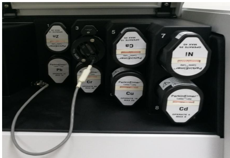
Slika 8. Šuplje katodne lampe korištene kao izvor svjetla
