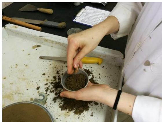
Slika 37. Usitnjavanje uzorka za određivanje vlažnosti
