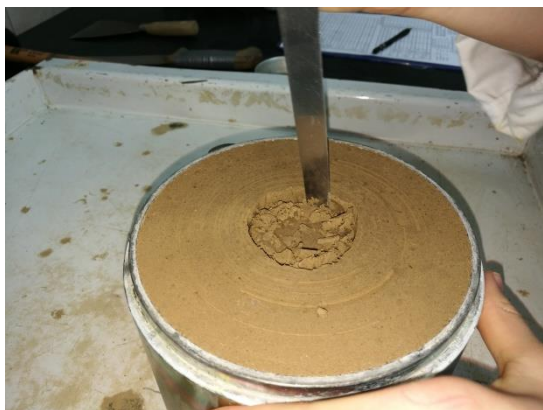
Slika 36. Vađenje uzorka za određivanje vlažnosti
