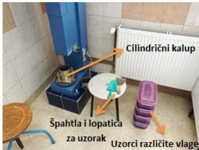
Slika 20. Priprema za izvođenje Proctor-ovog pokusa
