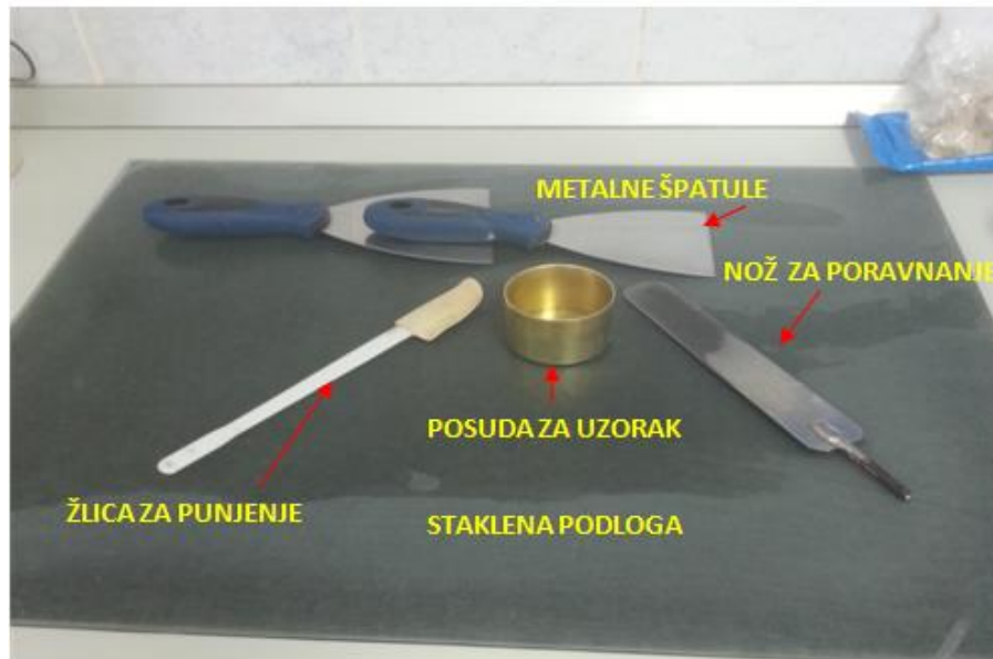
Slika 10. Oprema za određivanje granice tečenja padajućim šiljkom
