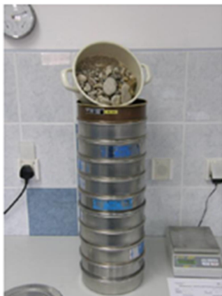
Slika 10. Mehanička tresalica sa odgovarajućim sitima različitih promjera otvora
