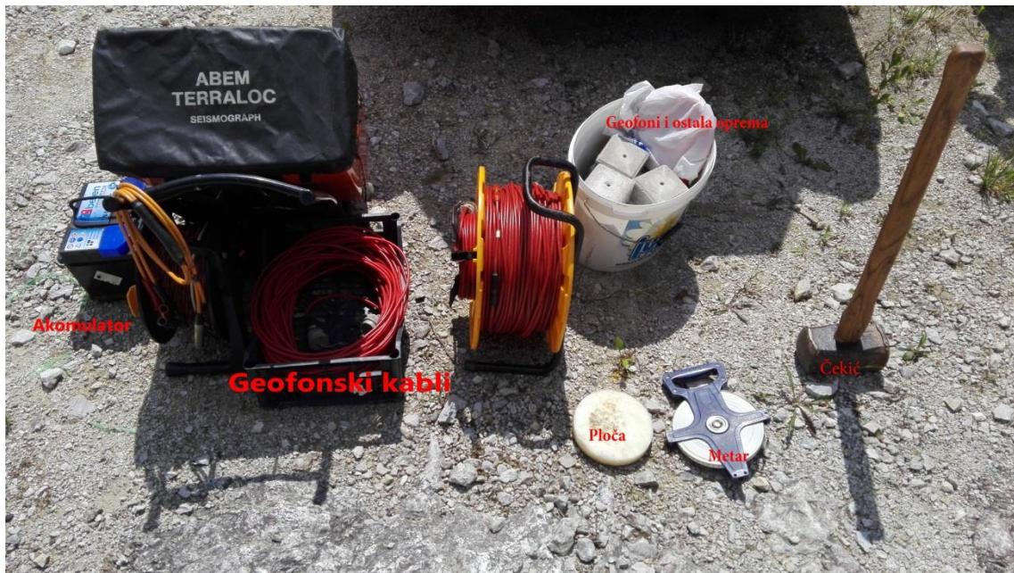
Slika 14. Oprema za seizmičku refrakciju
