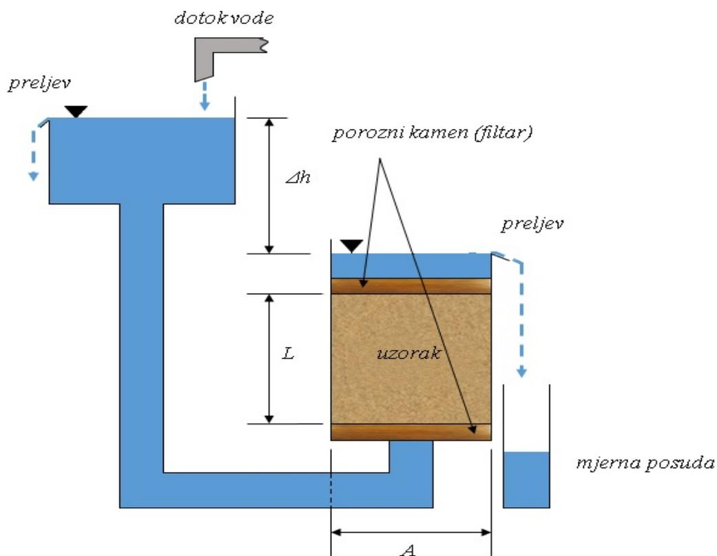
Slika 7. Mjerenje koeficijenta propusnosti metodom konstantnog tlaka
