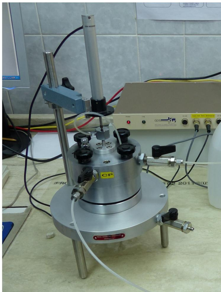
Slika 9. Hidraulički edometar
