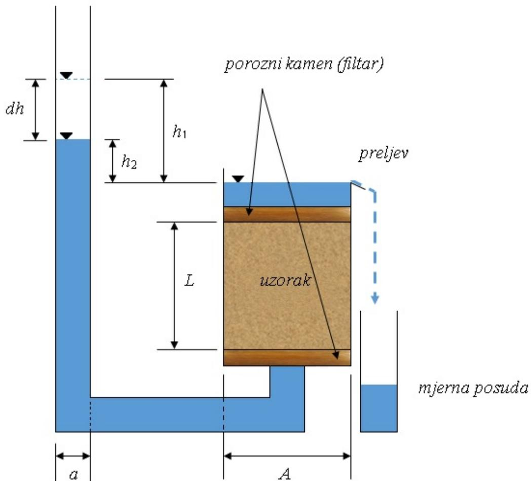
Slika 8. Mjerenje koeficijenta propusnosti metodom promjenjivog tlaka
