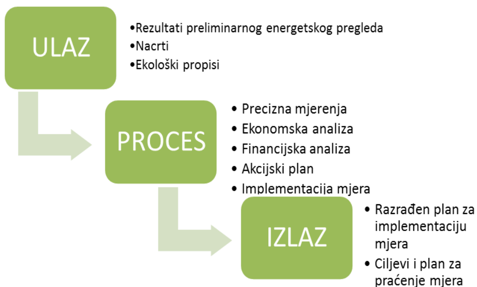
Slika 3. Shema detaljnog energetskeg pregleda
