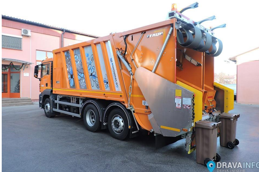
Slika 8 Dvokomorno vozilo za odvoz otpada sa stražnjim utovarivačem [17]
