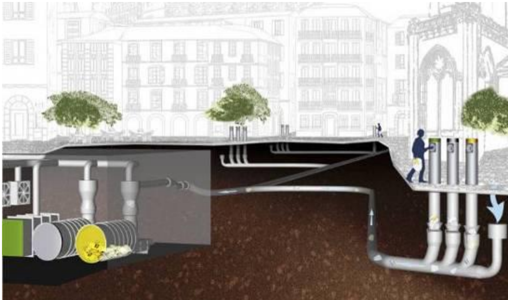
Slika 3 Postrojenje za pneumatsko skupljanje otpada u gradskim centrima [10]
