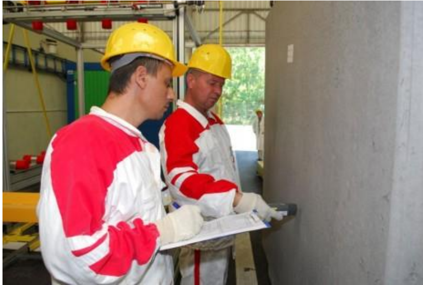
Slika 13 Radijacijska mjerenja na kontaktu stjenke paketa s radioaktivnim otpadom [26]
