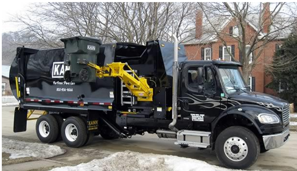
Slika 9 Kamion sa automatiziranim bočnim utovarivačem [18]
