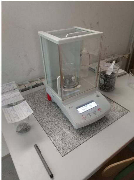
Slika 10. Prikaz odvage od 10 g uzorka
