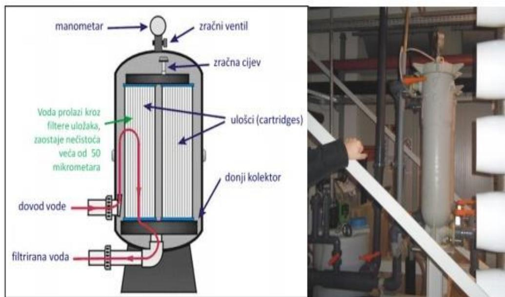
Slika 9. Princip rada svijećnogfiltera i filter u pogonu u Petrčanima [8]
