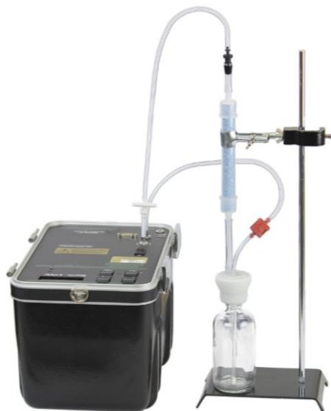
Slika 16. Uređaj RAD7 s dodacima za mjerenje radona u vodi [21]
