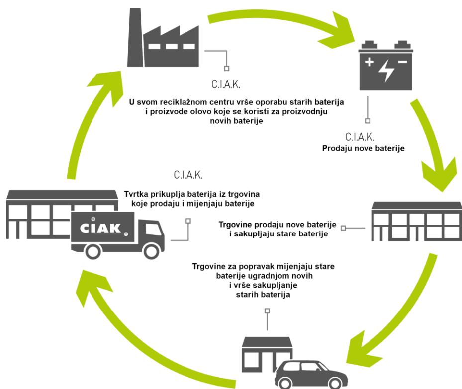
Slika 12 Proces rada s baterijama u tvrtki C.I.A.K. [24]
