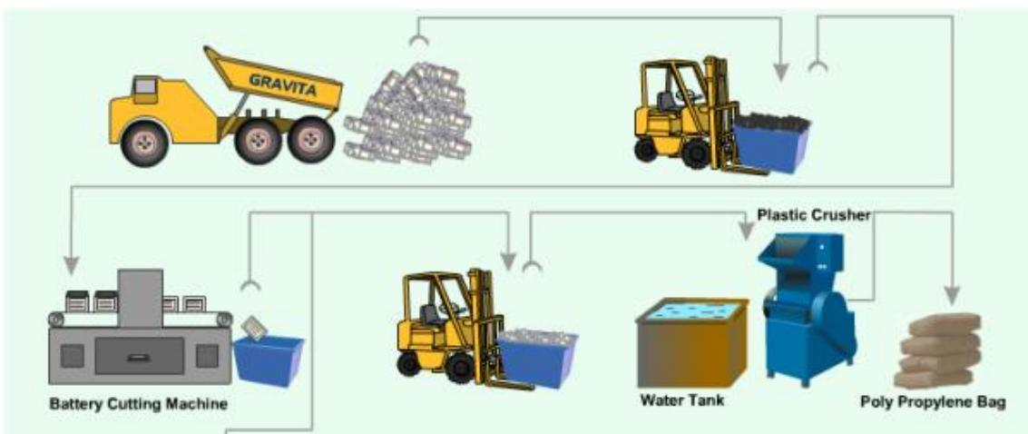
Slika 13 Shematski prikaz procesa recikliranja olovno – kiselih baterija i akumulatora
