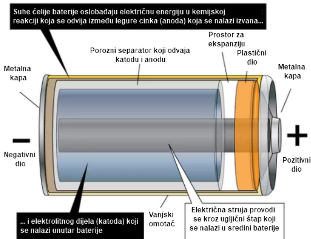
Slika 1 Izgled i dijelovi baterije [3]
