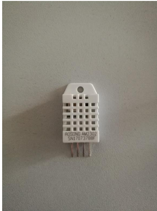
Slika 10. DHT22 senzor za mjerenje temperature i vlažnosti zraka
